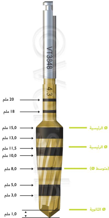
يتم إرواء مثاقب® Densah في الخارج وهي مصممة لاستخدامها عند سرعات ثقب تصل حتى 800 إلى 1500 دورة في الدقيقة. وعليها علامات ليزر بعمق يتراوح من 3 و20 ملم. كما أن مثاقب® Densah مستدقة الشكل، ورقم الكتالوج يوضح بعد القطرين الأصغر والأكبر لها. على سبيل المثال، يحتوي مثقب® Densah طراز VT3848 على (قطر ثانوي) يبلغ 3,8 ملم و(قطر رئيسي) تاجي يبلغ 4,8 ملم عند علامة الليزر بقياس 11,5 ملم بمستوى قطر متوسط يبلغ (4,3 ملم) عند علامة الليزر بقياس 8 ملم، والذي يصبح قطره الذروي للغرسات قصيرة الطول  $\geq 8$  ملم.
